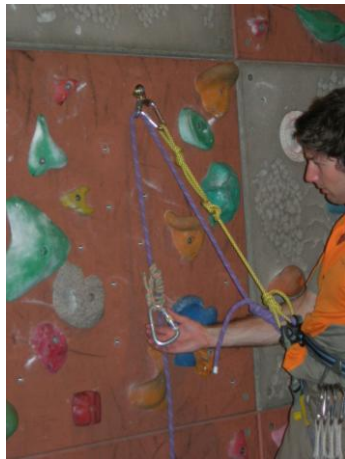
relier le marchard au pontet par un mousqueton à vis
